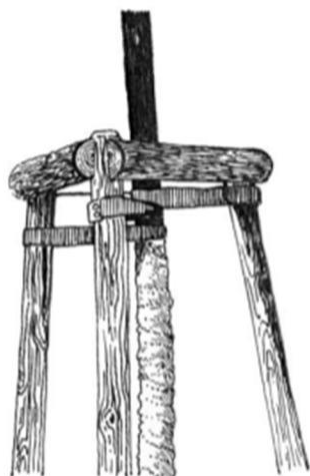
Obr. 2: Úvazky k uchycení stromu ke kůlu
